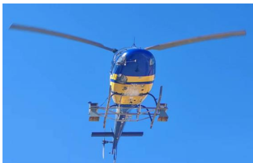
图 5 天线系统 Fig.5 Antenna system
