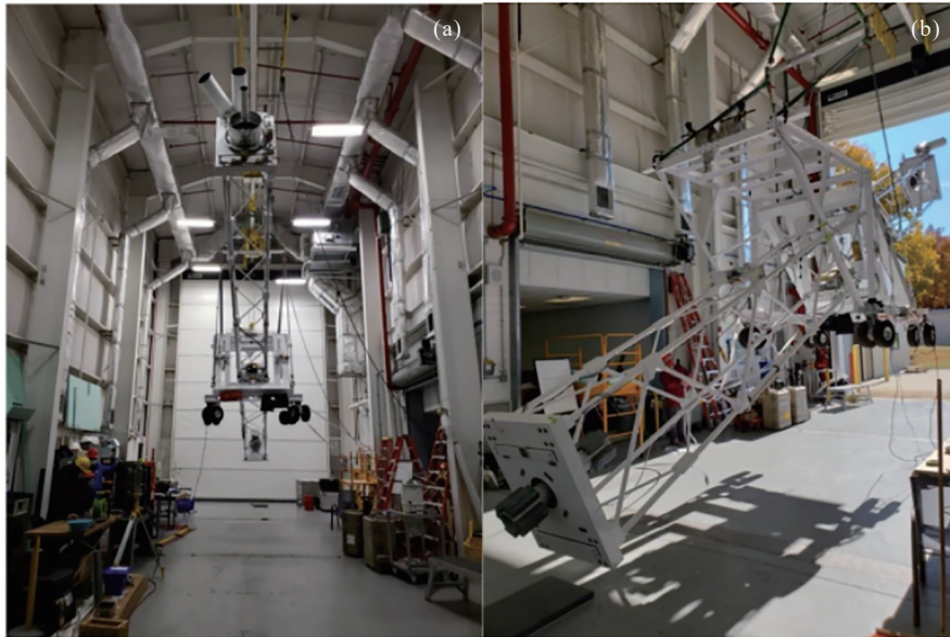
图 22 Wallops 飞行中心集成测试期间的 XL-Calibur. (a) 夜间星跟踪器测试期间的前视图, (b) 白天太阳传感器测试期间的侧视图
