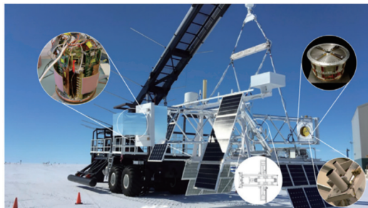
图 20 X-Calibur 有效载荷及其主要部件在麦克默多长时气球设施的最终兼容性测试
