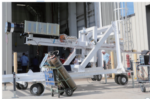
图 23 BITSE 日冕仪集成到 WFF (Wallops 飞行中心) 的吊舱和 WASP 系统中
